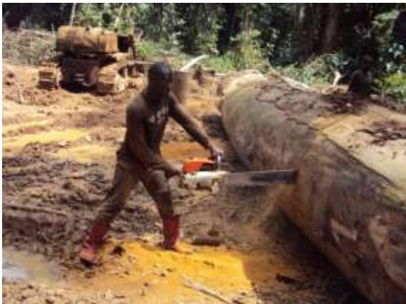
Photo 12. Commis au tronçonnage sans équipement de sécurité
