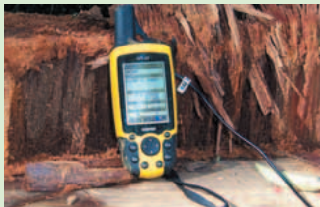
Enregistrement de la location d'une souche par l'Observateur à l'aide d'un GPS pour vérifier si l'exploitation a eu lieu au sein des limites du titre alloué
